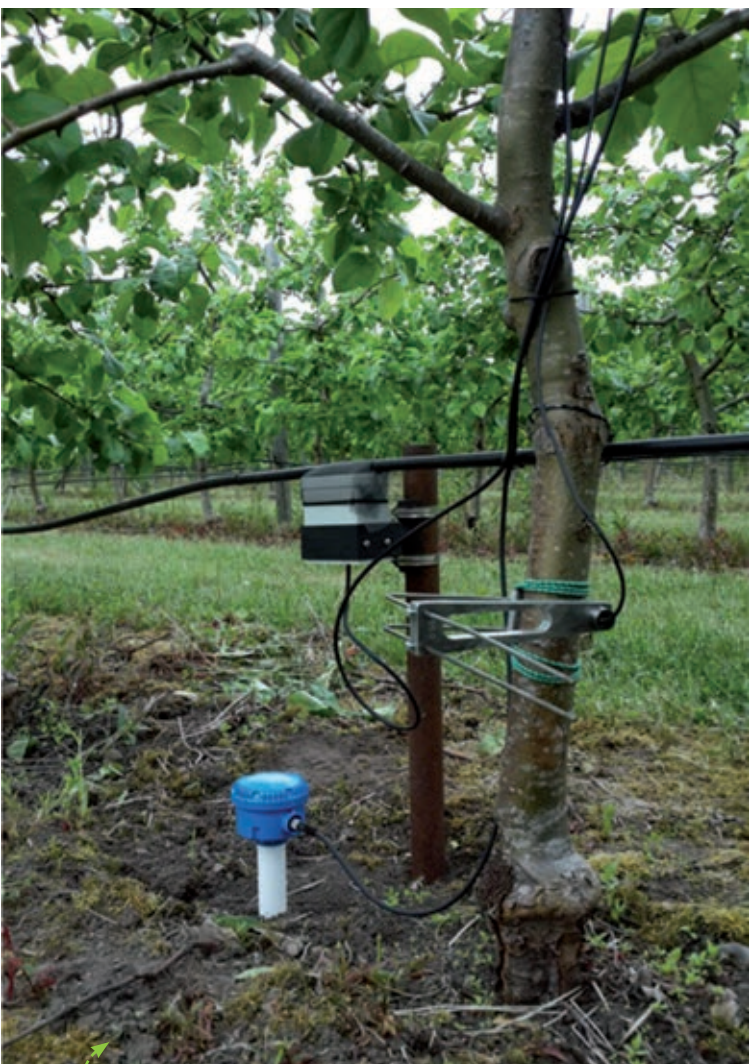
Unidad de seguimiento del estado hídrico del agua en suelo y planta para evaluación de las necesidades hídricas del cultivo.
